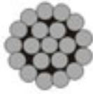
art. št. 8378 Žična vrv pletanje 1 x 19
